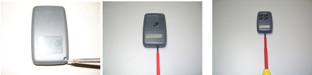
Mit Werkzeug (z. B. Schraubendreher mit passender Klinge) durch leichtes Drehen öffnen
