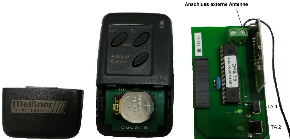
Abb. 10: Rolling Code Sender und Empfänger
