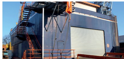
Rolltor als Außenabschluss auf einem Seeschiff montiert
