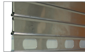
Rolltor-Lamelle M20 Doppelwandig Alu natur/Kunststoff-Isolierschale mit Hartschaumkern, geschlossenes Profil (nur als Innenroller geeignet)
