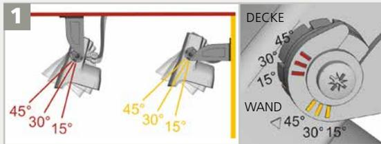
Den Winkel des Sensors einstellen um das Erfassungsfeld korrekt zu positionieren.
