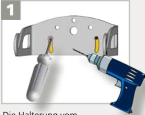
Die Halterung vom Sensor entfernen. 2 Löcher bohren. Die Halterung festschrauben.
